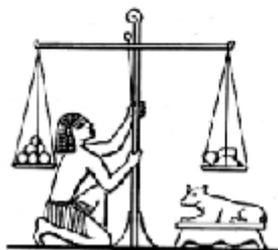
При взвешивании на рычажных весах на одну чашку кладут взвешиваемое тело, на другую – гири. Гири подбирают так, чтобы установить равновесие. При этом уравниваются массы взвешиваемого тела и гирь. Если уравновешенные весы перенести, например, на Луну, где вес тела меньше, чем на Земле, в 6 раз, равновесие не нарушится, так как вес и тела, и гирь на Луне уменьшился в одинаковое число раз, а масса осталась прежней.
